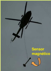
La imagen de la izquierda muestra cómo se realiza una magnetometría aérea. El sensor magnético se aloja dentro de una estructura aerodinámica, denominada bird, que cuelga a 30 metros por debajo del helicóptero. La imagen superior es una fotografía del cráter del volcán Stromboli en las islas Eolias (Italia), tomada desde el helicóptero mientras se realizaba un vuelo aeromagnético. Stromboli es el único volcán del mundo con actividad intermitente desde hace 2500 años.
